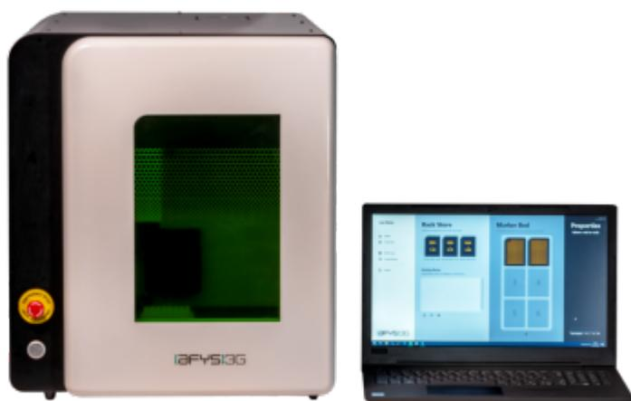
Автоматическая система маркировки пробирок AFYS3G Lambda576 — это первый в своем роде автоматизированный лазерный маркер, предназначенный для замены ручного или даже автоматического нанесения этикеток на трубки, которые могут быть подвержены ошибкам. Это очень полезное устройство, особенно в связи с постоянно растущими требованиями к хранению небольших объемов образцов в небольших пробирках возможность маркировки обычно невозможна или во многих случаях не подходит для автоматизации.
